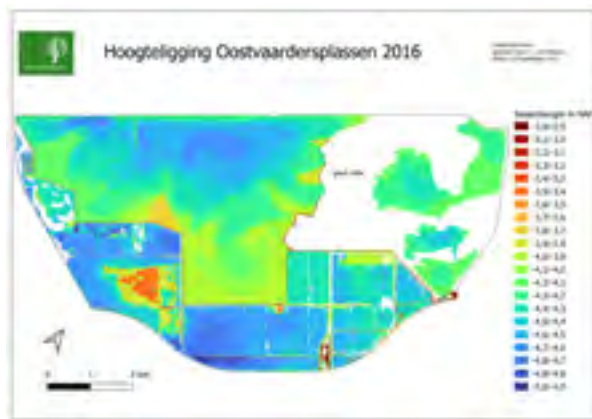
Figuur 2.2 Bodemhoogte van de Oostvaardersplassen. De bodemhoogte ligt tussen de -2,9 en 5,0 meter NAP. Data ontbreekt voor delen van het oostelijk moerasdeel.
