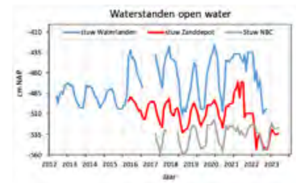
Figuur 2.5 Waterstanden open water in het grazige deel. 'Stuw Waterlanden' geeft het open waterpeil van de natte graslanden weer. 'Stuw Zanddepot' geeft het open waterpeil van de niet geïnundeerde (droge) graslanden ten zuiden van de Waterlanden weer. De stuw nabij het Natuur Belevingscentrum (NBC) bepaalt het peil van de droge graslanden aan de westkant. Vanaf 2016 is de stuw in de Waterlanden verhoogd waardoor daar weer de hoge voorjaarsstanden worden bereikt zoals in het verleden. In 2021 zijn de stuwen tijdelijk verhoogd en in 2022 tijdelijk verlaagd in verband met werkzaamheden.
