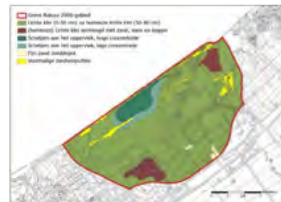
Figuur 2.1 Bodemkaart van de Oostvaardersplassen in 1990, gebaseerd op de kaart uit Jans & Drost (1995). Het grootste deel van de bodem bestaat uit lichte klei.
