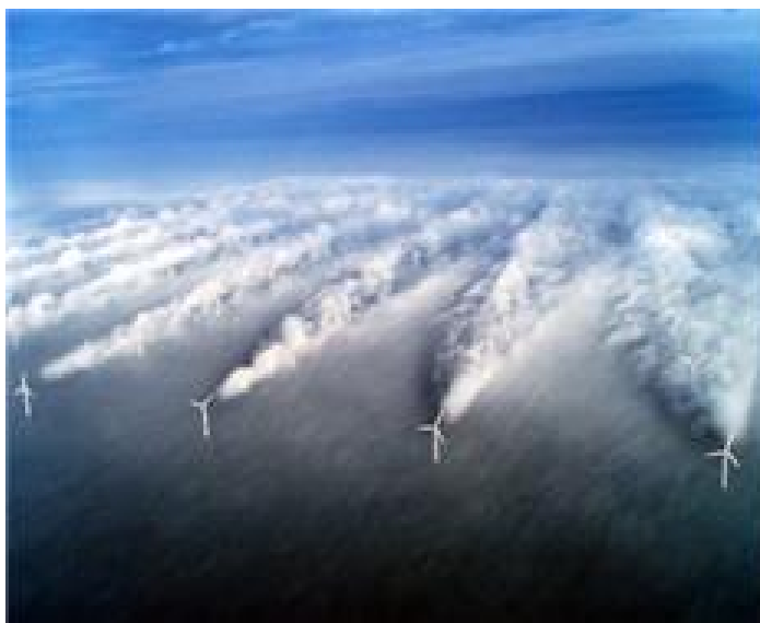
Afbeelding 1: Turbulentiepatroon achter windturbines
