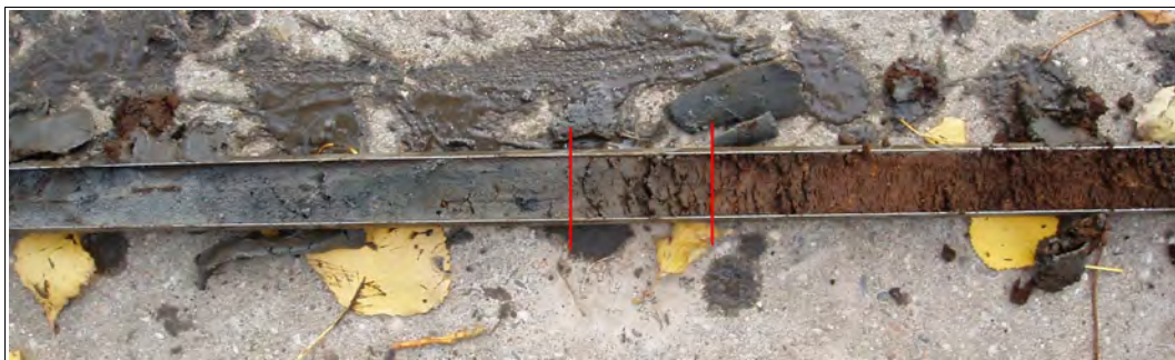
Figuur 9: Swifterbant, Visvijverweg 14: monster boring 13 van circa 425 tot 475 centimeter diepte (-9,7 tot -10,2 meter NAP). Ook hier zijn drie lagen zichtbaar: links pleistoceen zand, midden humeus leem, rechts (basis)veen.
