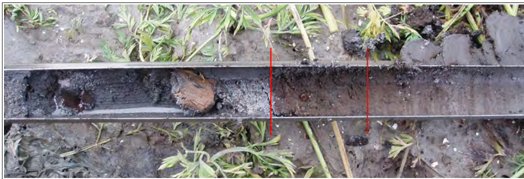
Figuur 8: Swifterbant, Visvijverweg 14: monster boring 4 van circa 470 tot 490 centimeter diepte (-9,0 tot -9,2 meter NAP). Er zijn drie lagen zichtbaar: links pleistoceen zand met houtresten, midden kleiig (basis)veen, rechts gelaagde matig slappe licht humeuze zeer zware klei.
