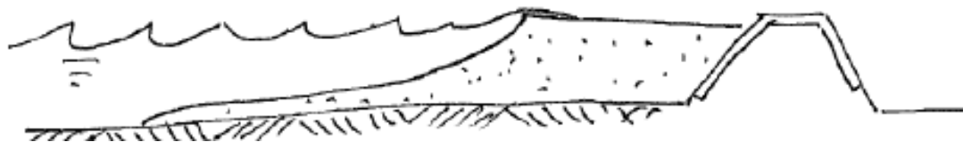
figuur 2 Restprofiel haventerrein draagt bij aan maatgevende hoogwaterstanden
